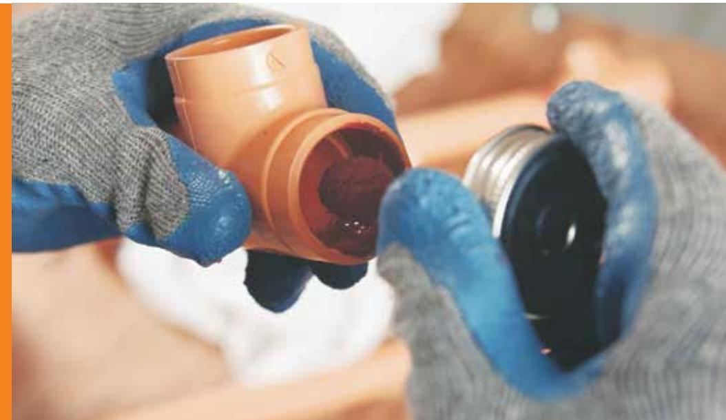
Hàn dung môi hòa tan là một quy trình lắp đặt nhanh chóng, dễ dàng sử dụng dung môi và nhựa CPVC để kết dính kiểu hóa học giữa ống và phụ kiện với nhau ở cấp độ phân tử. Dung môi hiệu quả và an toàn khi sử dụng. Cuối cùng, sử dụng dung môi hòa tan không phải chỉ kết dính hai mảnh lại với nhau mà còn tạo ra một mảnh nhựa liên tục. Mối nối trở thành phần chắc chắn nhất của hệ thống đường ống.
